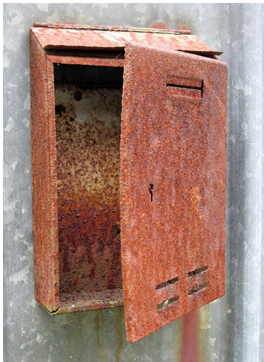
FIGURE 3 – Une boîte aux lettres rouillée sur une plaque galvanisée intacte.
