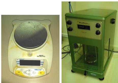
FIGURE 2 – Balance au centigramme (gauche) et au milligramme (droite).
